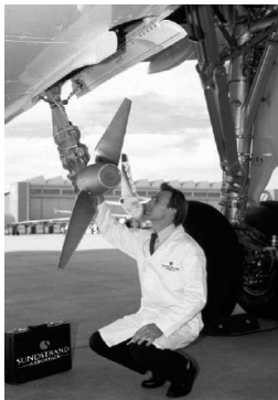
Izquierda: RAT instalada en fuselaje ventral. Derecha, ensayo de RAT en condiciones de formación de hielo. NASA Icing Research Tunnel.
